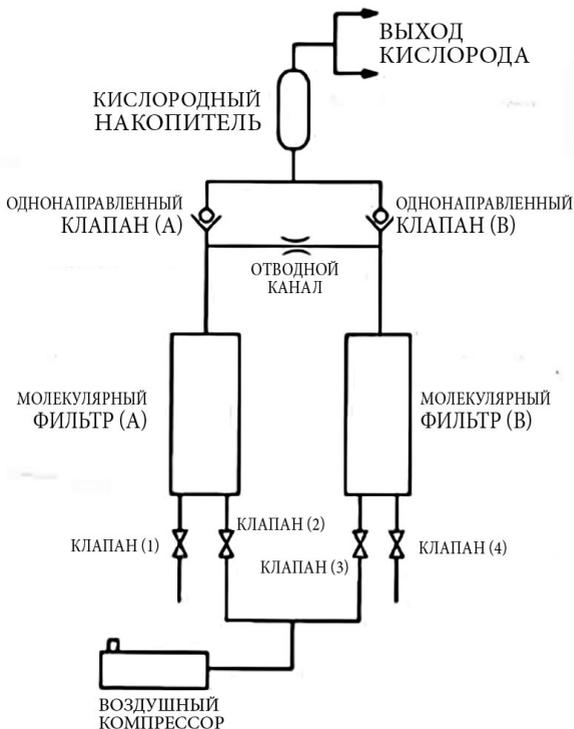
Воздух, сжатый работающим воздушным компрессором поступает на молекулярный фильтр (А) через открытый клапан (2). Азот адсорбируется и кислород, проходя сквозь фильтр (А) через однонаправленный клапан (А), поступает в специальный кислородный накопитель. Затем кислород через клапан-регулятор давления и объемный счетчик поступает в увлажнитель для насыщения влагой. После этого, он становится пригодным для дыхания человеком.
